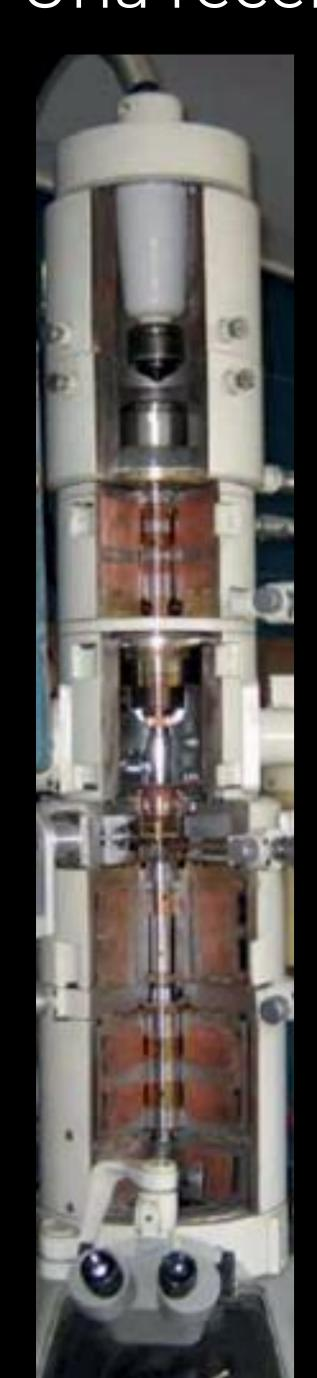
1. Il microscopio elettronico a Trasmissione (TEM) per produrre il fascio di elettroni e misurarlo.
