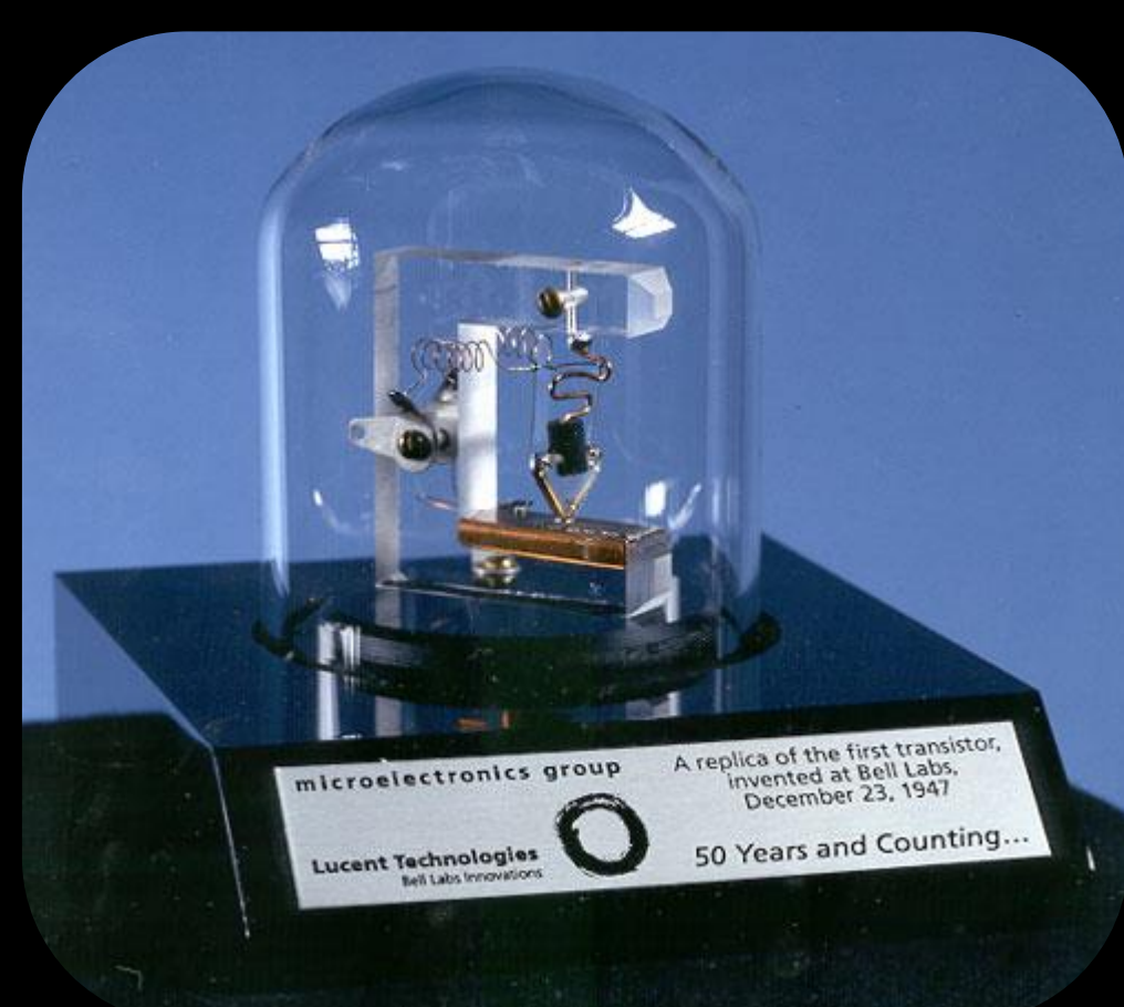
John Bardeen, Walter Brattain e William Shockley Prima tipologia di transistor 1947
